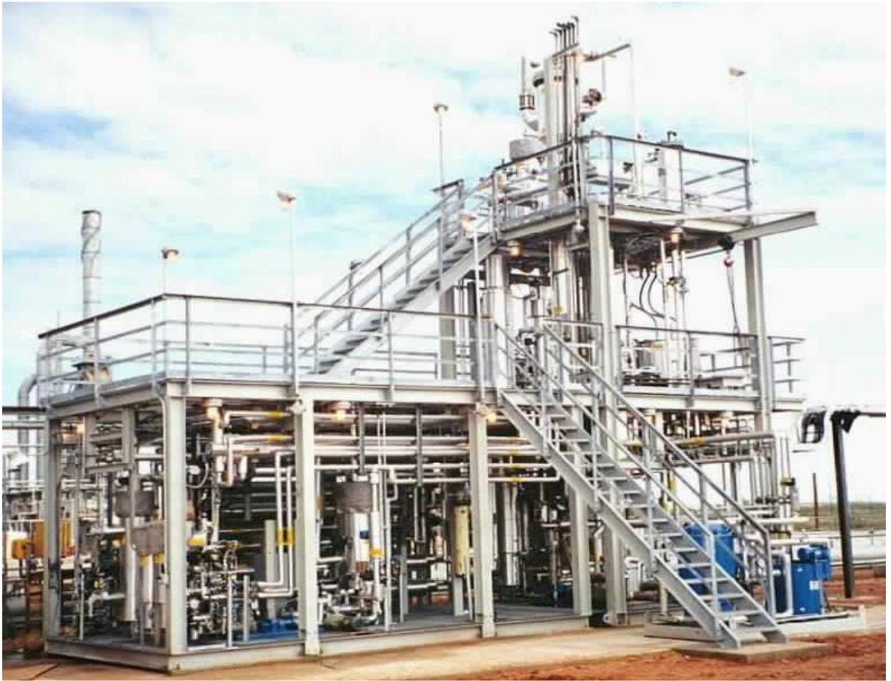
**Figure 2. CrystaSulf Pilot Unit**
